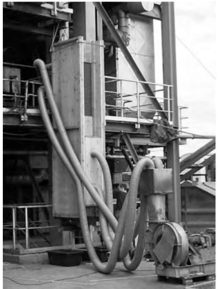
Abbildung 3: Pilotanlage eines Schachttrockner
