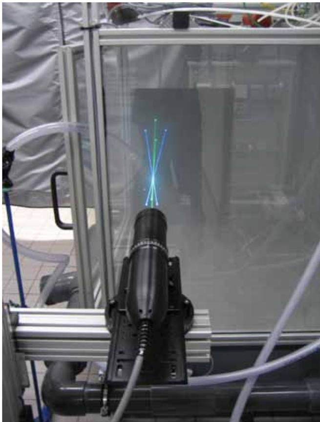
Abb. 2: LDA-Transmittersonde und das Messvolumen im Schnittpunkt aller Laserstrahlen
