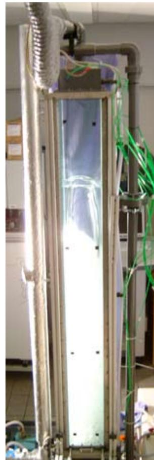
Abb. 1b: Laborblasensäule - Durchbruch des Gases
