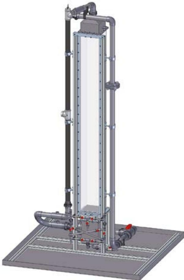
Abb. 1a: 3d-Modell der Laborblasensäule
