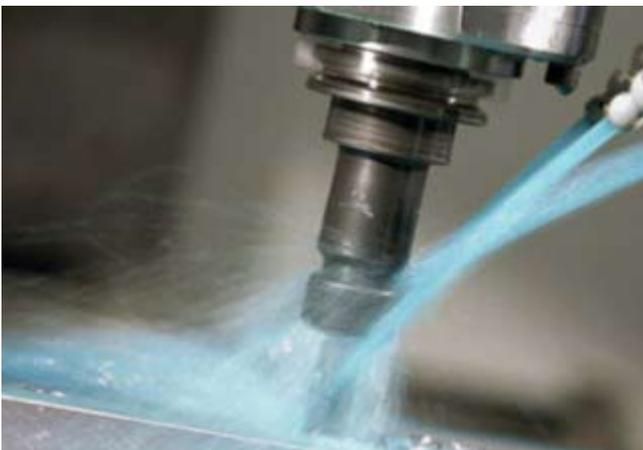
Abbildung 1: Kühlschmierstoffzuführung an einer Bearbeitungsstelle (www.dastuart.com)
